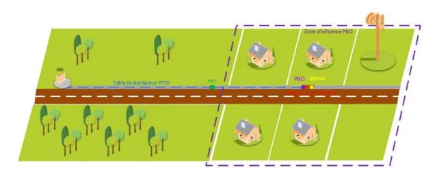
Ce boitier sera positionné dans le réseau d'infrastructure existant à proximité immédiate du PBO, dans la même chambre ou sur le même appui. La distance entre le PBO et le BRAM ne devra pas excéder 1 mètre.
