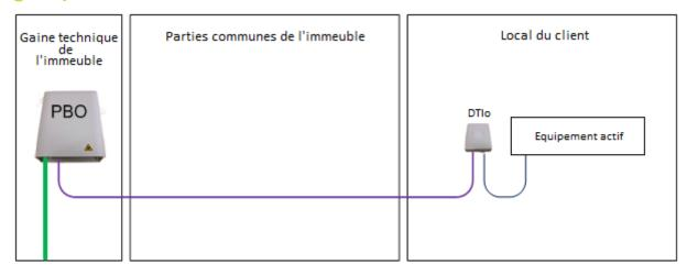
Le passage du câble optique, entre le PBO et le DTIo est fonction de l'implantation du PBO. Il peut être réalisé de trois manières :
