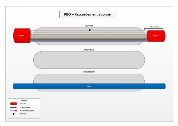
En cas de mauvaise manipulation et de rupture de fibres non concernées par le raccordement, sur le tube fenêtré, l'intervenant devra procéder aux épissures nécessaires pour rétablir la continuité.
