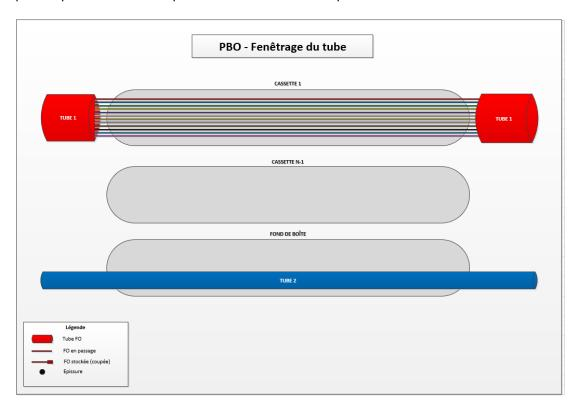
2. Identifier la fibre à utiliser en fonction des informations transmises par l'opérateur d'immeuble et l'arrêter dans la cassette.
