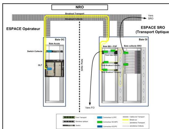
L'opérateur commercial indiquera à l'opérateur d'infrastructure le numéro du port qu'il souhaite activer (n° de tiroir, n° de connecteur) correspondant au pré-câblage réalisé (les connecteurs étant repérés).
